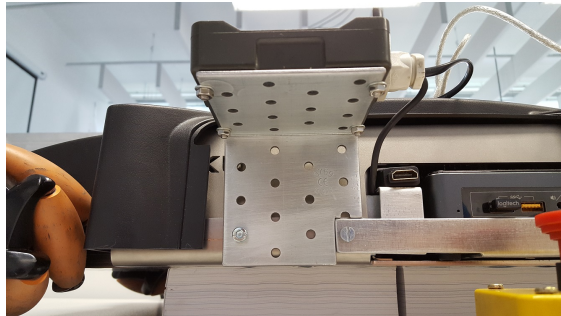
Abb. 4.14.: Not-Aus Unterseite montiert
